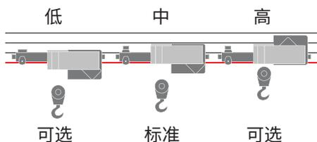
CXT钢丝绳电动葫芦采用不同的小车配置,可有效利用厂房高度尺寸,满足不同的起吊作业需求。
