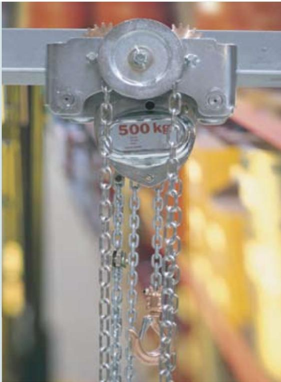
手动环链葫芦的载重能力为10吨以下，可分为悬挂式或手推式及链条式，零部件材料为青铜、不锈钢、镀青铜、镀黄铜材料以保证危险作业区内的安全性，本吊车另可带有载重限制器及链盒装置，此外，科尼起重机可提供各种手推式及手动行车，可单独与不同类型的型钢梁配套使用。
