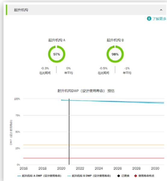
起重机DWP是对起重机构剩余使用寿命的计算，也是机械部件剩余疲劳寿命的指示。当DWP值接近零时，应大修或更换起重机构。
