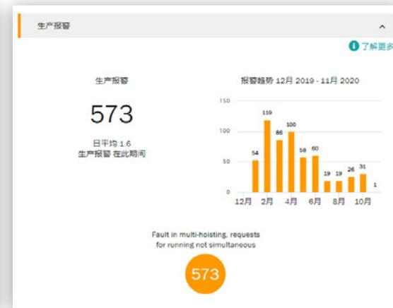
这些都表明了导致起重机停工或停产的生产风险。生产关键风险包括电机过热、变频器故障和控制系统故障。
