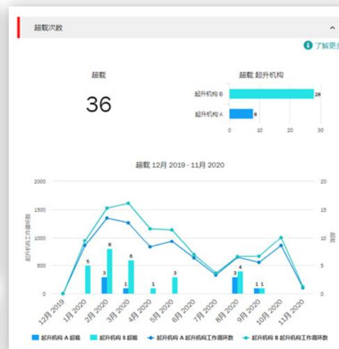
负荷部分的载荷谱显示了起升机构平均运行时与额定负荷的接近程度。
