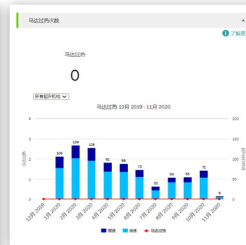
图中显示了双速电机低速和高速运行的比例以及同期过热报警出现的次数。
