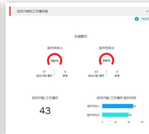
表示变频控制电机和双速电机的启动次数，以及双速电机的转速变化情况。
