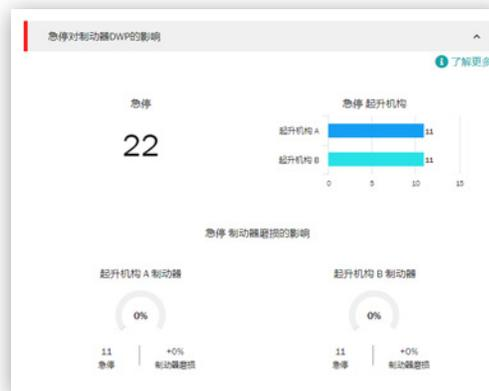
图中显示每期累计紧急停车次数和制动器的使用寿命趋势。
