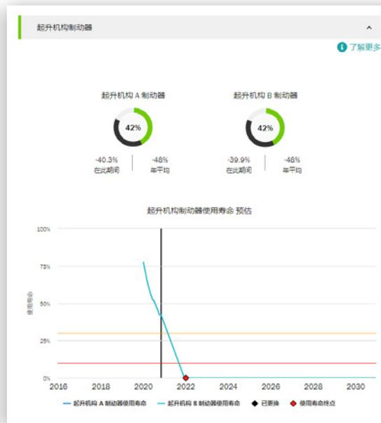
该部分显示制动器的计算剩余使用寿命。当该值接近零时，应更换整个制动器（电磁盘式制动器），或是全面检查制动器（靴式制动器及推力盘式制动器）。
